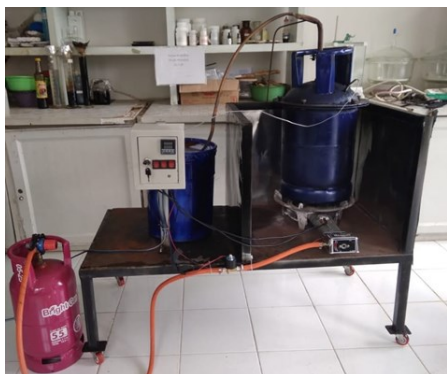
Gambar 1. Set pirolisator portable Sumber: Dokumentasi Pribadi Tahun 2021
