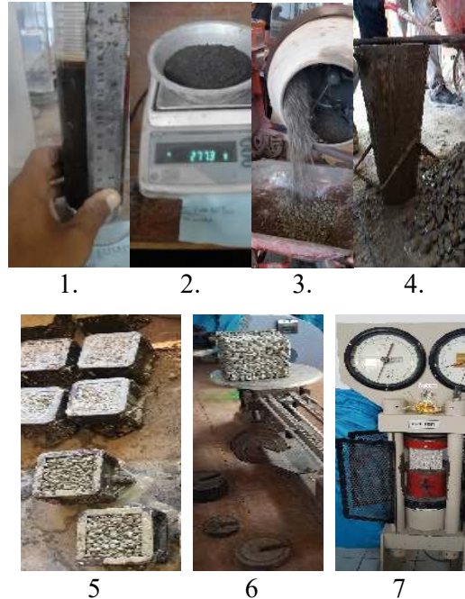
Gambar 4. 1 : Pemeriksaan kadar lumpur, 2 : Pengukuran berat jenis, 3 : Pencampuran benda uji, 4 : Pengujian nilai slump, 5 : Pencetakan benda pengujian, 6 : Pengujian berat volume beton, 7 : Pengujian kuat tekan beton
