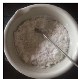
Gambar 2. Hasil Endapan Serbuk Urea-Hidroksiapatit Setelah Proses Pengeringan
