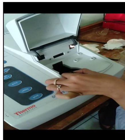
Gambar 5. Pengukuran Kandungan Logam Berat dengan Spektrofotometri
