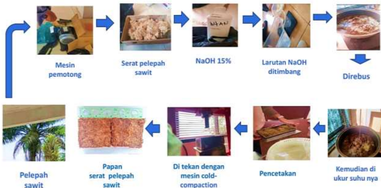
Gambar 1. Fabrikasi papan serat pelepah sawit
