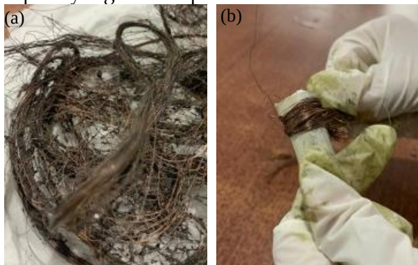
Gambar 2 (a) Serabut Cu setelah direndam, (b) Serabut Cu dililitkan pada penyangga
