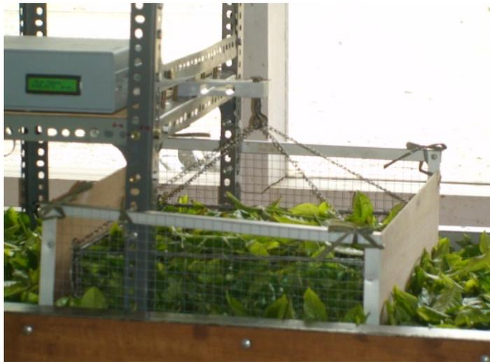
**Gambar 5.** Perangkat keras akuisisi pada palung pelayuan
