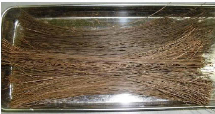
Gambar 1. Serat bambu yang digunakan dalam sintesis bahan komposit ramah lingkungan.
