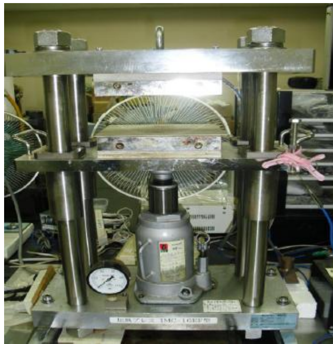
Gambar 2. Mesin pengepres yang digunakan dalam pembuatan bahan komposit.
