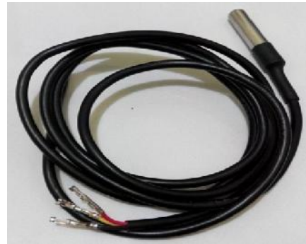
Gambar 1. Bentuk Fisik Probe sensor LM35 (Indoware, 2016)
