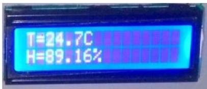
**Gambar 5.** Tampilan LCD hasil pengukuran temperatur dan kelembaban.
