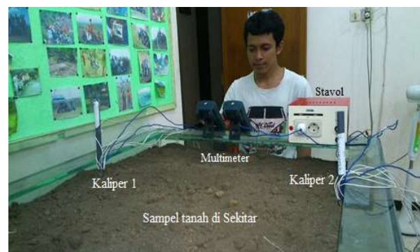
Gambar 2 Susunan peralatan pengukuran pada bak kaca sebagai wadah model pergerakan limbah minyak goreng
