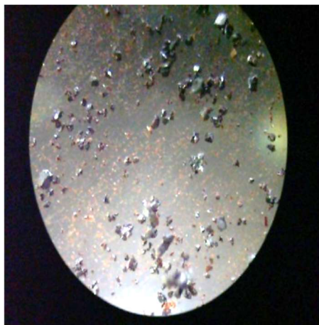
Gambar 4. Foto karakterisasi mikroskop optik dengan perbesaran optis 130 kali terhadap sampel oksida besi teraktivasi asam sitrat yang lolos kertas saring Whatman No. 42 pada perbesaran optis 130 kali (A) dan perbesaran optis 520 kali (B).
