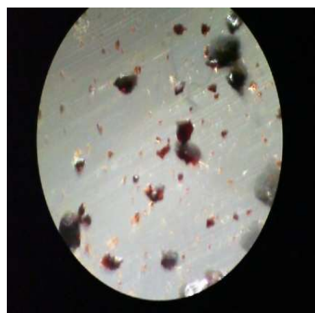
Gambar 4. Foto karakterisasi mikroskop optik dengan perbesaran optis 130 kali terhadap sampel oksida besi teraktivasi asam sitrat yang lolos kertas saring Whatman No. 42 pada perbesaran optis 130 kali (A) dan perbesaran optis 520 kali (B).
