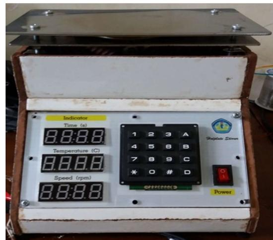
Gambar 7 Realisasi alat *hot plate stirrer*
