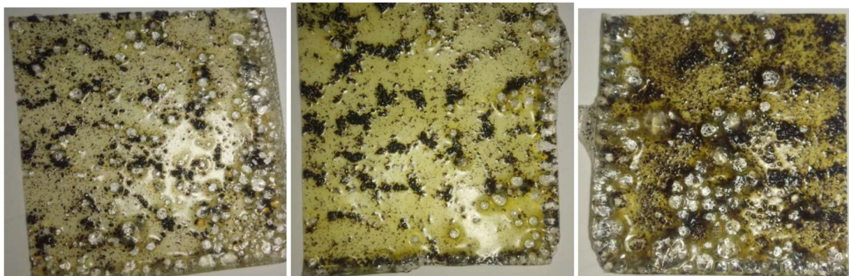
Gambar 5 Sampel polimer termoplastis biodegradable , dengan perbandingan Sampel TKPTT:LDPE sebesar (a) 1:3, (b) 2:3, dan (c) 3:3
