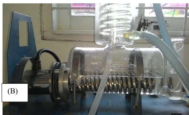
**Gambar 6 (A) Kotoran menempel pada dinding pemanas, dan (B) Alat destilasi yang sudah dibersihkan**
