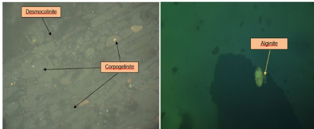
Gambar-3. Fotomikrograf maseral batubara Warukin Seam O. Maseral Vitrinit (Deskomolinit dan Corpogelinit) dan hadimya maseral penyerta Alginite. fluorescence mode, 500x
