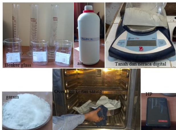
Gambar-4 Alat dan Bahan Uji Sedimentasi
