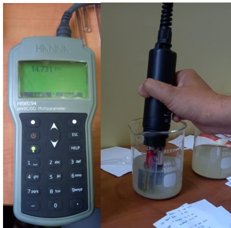
Gambar-5 Alat multiparameter Hanna
