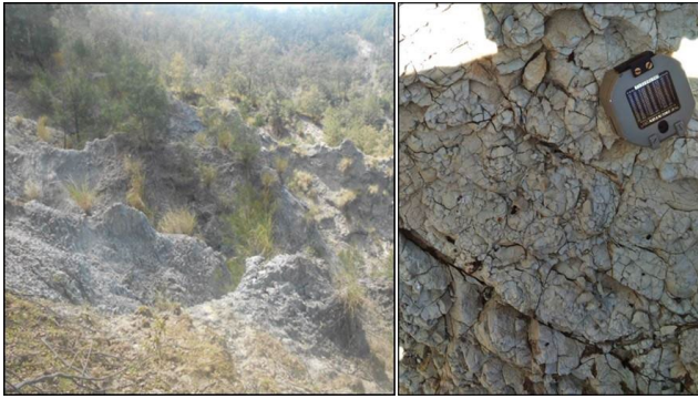
Gambar-8. Gejala slaking berupa hancurnya material yang terjadi pada batulempung Formasi Bobonaro [2].
