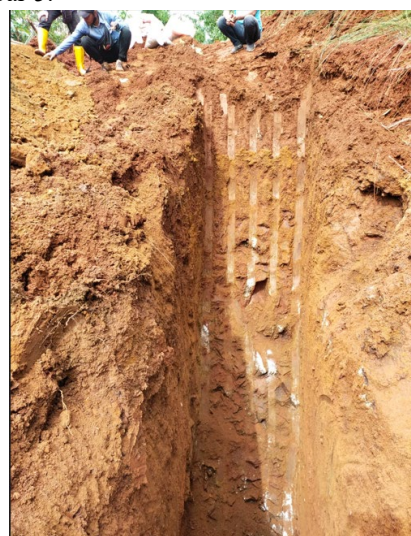
Gambar-5. Hasil Bukaan dengan Metode Test Pit
