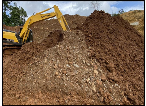
Gambar-8. Tumpukan ore dan overburden
