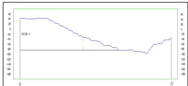
Gambar-6. Geometri lereng aktual
