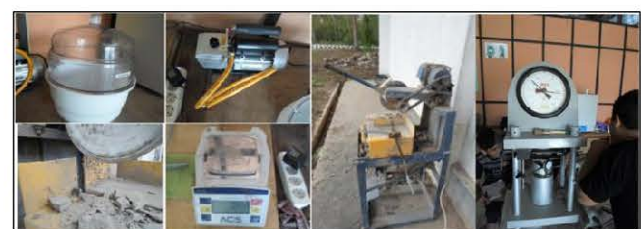
Gambar-6. Instrumen penelitian : desikator (kiri atas), vacuum (tengah atas), gerinda (kiri bawah), timbangan (tengah bawah), alat potong dan alat uji kuat tekan (kanan)
