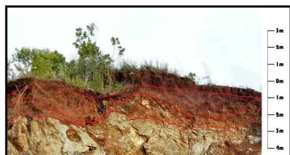
Gambar-2. Penampang Umum Endapan Laterit
