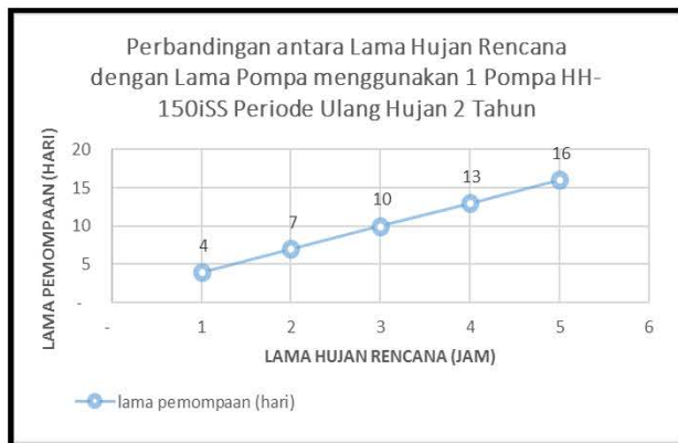
Gambar-1. Grafik Perbandingan antara Lama Hujan Rencana dengan Lama Pemompaan Menggunakan 1 Pompa HH-150iSS Periode Ulang 2 Tahun
