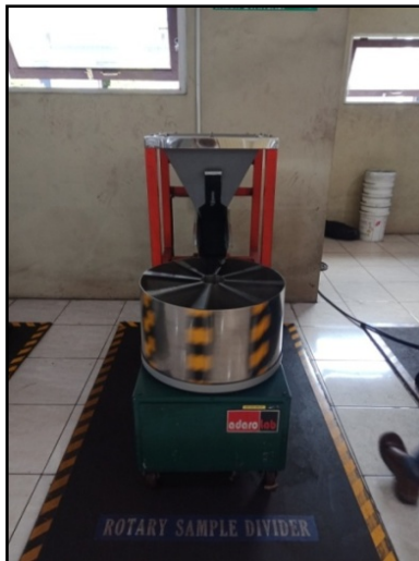
Gambar-6. Proses pembagi sampel dengan Rotary Sample Divider/RSD
