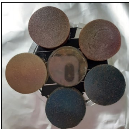
Gambar-3 Sampel poles untuk analisis mikroskopi
