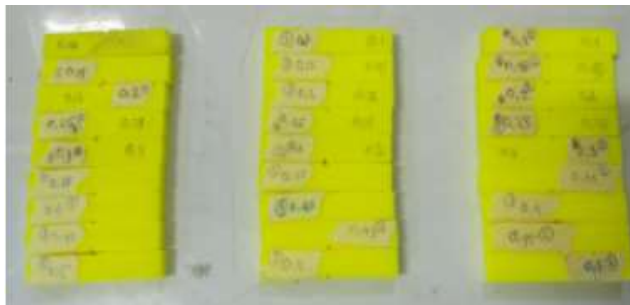
Gambar 6. Spesimen Plastik dari hasil Printer 3D yang diuji Pukul Charpy
