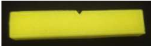
Gambar 4. Hasil Spesimen Plastik Uji Pukul Charpy dengan Printer 3D
