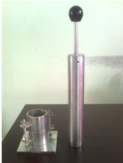
Gambar 2. Alat Uji Kepadatan Ringan Dengan Model
