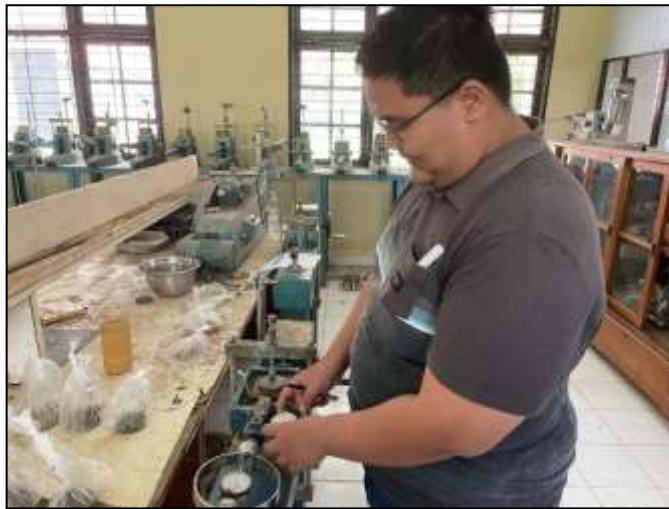
Gambar 3. Proses Uji Kuat Geser Langsung
