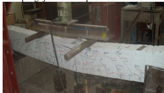
Gambar 15. Pola Retak benda Uji balok kontrol (BK) hasil pengujian
