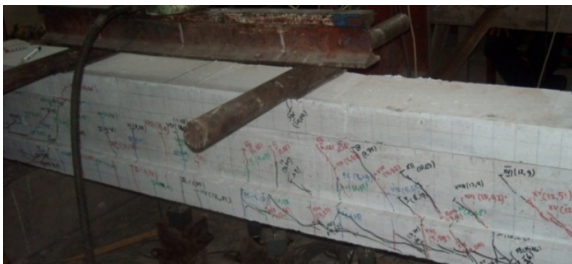
(a) Pola retak benda uji BP
