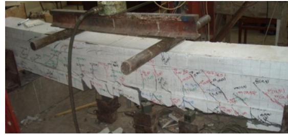
(b) Debonding selimut perkuatan BP
