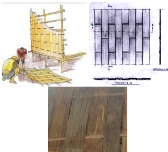
Gambar 15. Konstruksi Dinding Ba-anyam Sumber: Muchammad (2007) dan Arsip Penulis, 2006
