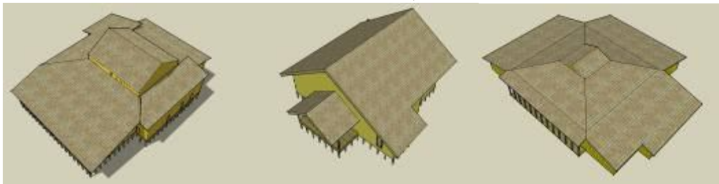
Gambar 19. Tipologi Atap Rumah Balai Desa Malinau (Kiri: Balai Bidukun, Balai Jalai, Balai Padang) Sumber: Muchammad, 2007
