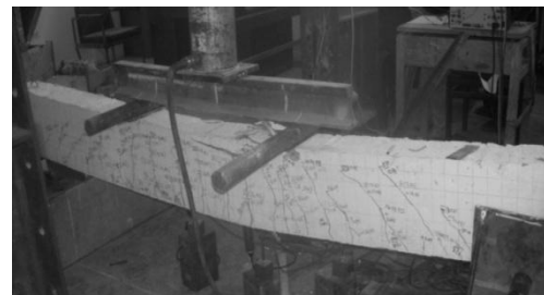
Gambar 11. Pola Retak benda Uji balok kontrol (BK) hasil pengujian
