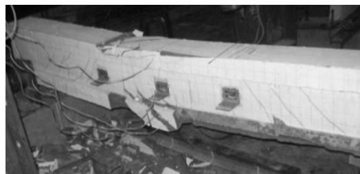
Gambar 15. Pola Retak dan terjadinya debonding benda uji BP-2
