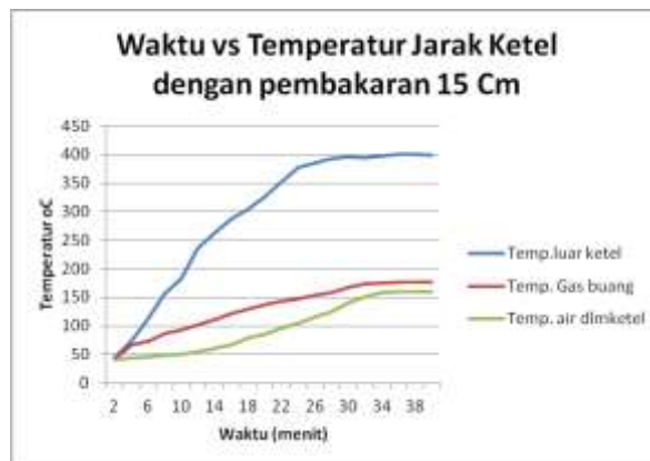
Gambar 3.3 Profil Temperatur pemanasan dengan jarak 15 Cm dari pembakaran
