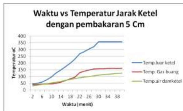
Gambar 3.1 Profil Temperatur pemanasan dengan jarak 5 Cm dari pembakaran
