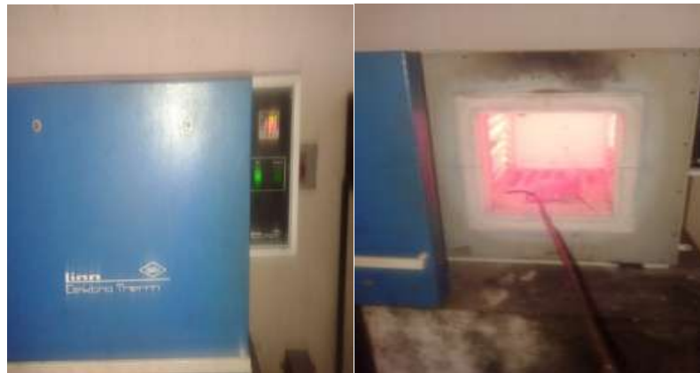
Gambar 3.2 Proses heat treatment pembentukan fasa ganda
