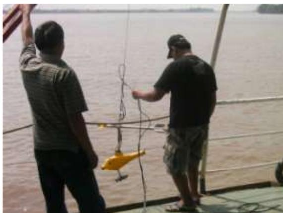
Gambar 5. Pengukuran Kecepatan di muara sungai Katingan dengan menggunakan *Currentmeter*
