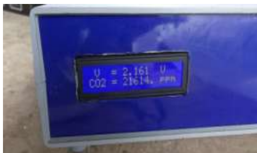
Gambar 13. Panel indikator CO 2 analyzer biogas tanpa pemurnian
