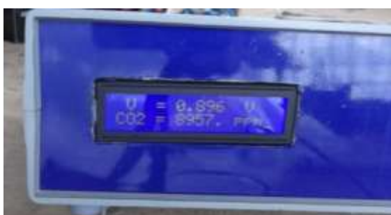
Gambar 14. Panel indikator CO 2 analyzer biogas dengan pemurnian
