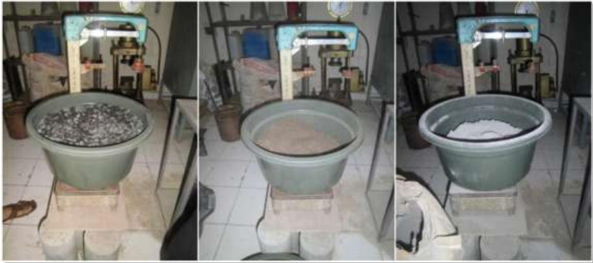
Gambar 1. Menimbang Agregat Kasar, Agregat Halus, dan Semen
