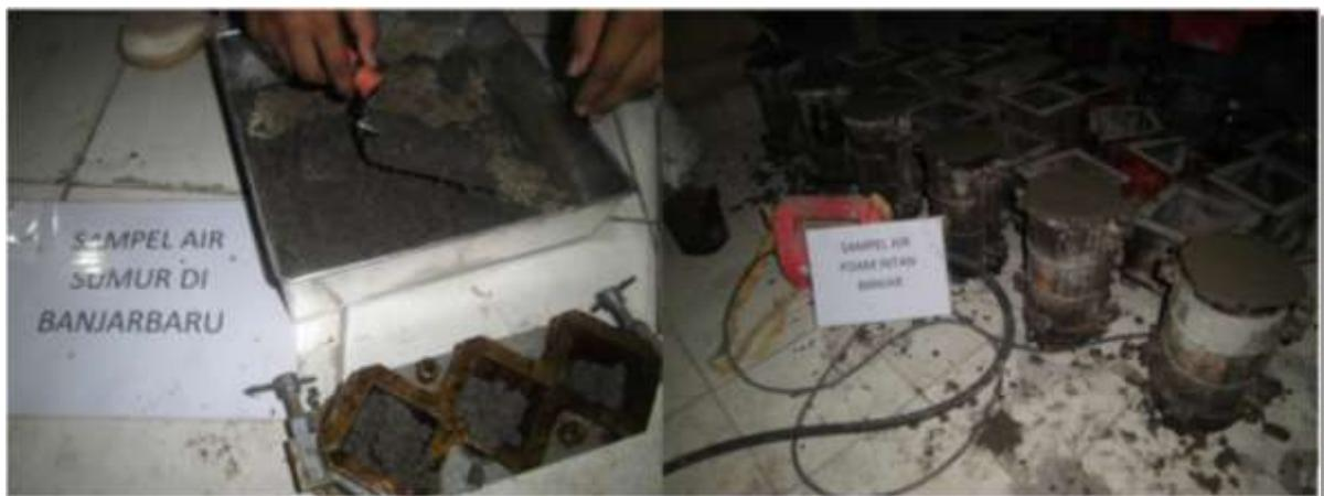
Gambar 4. Pencetakan Benda Uji Kubus dan Silinder
