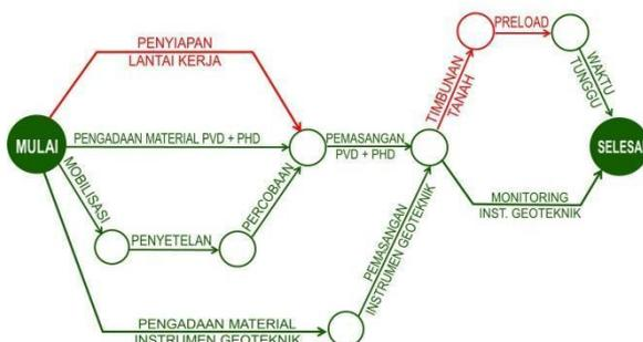
**Gambar 59.** Metoda *preloading* dengan PVD
