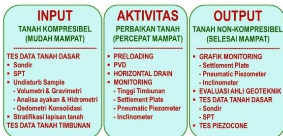
**Gambar 12.** Proses *preloading* dengan PVD
