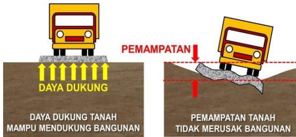
Gambar 3. Syarat tanah pendukung bangunan
