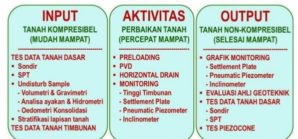
Gambar 12. Proses preloading dengan PVD
