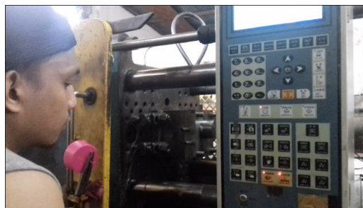
Gambar 2. Percobaan Pada Suhu 165^{\circ} C dan Tekanan 25 Bar Hasil Produk Tidak Jadi
