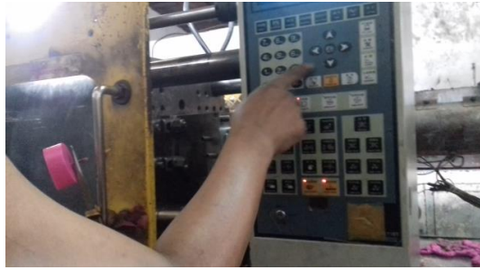
Gambar 3. Percobaan Dengan Suhu Dinaikkan Pada Suhu 170^{\circ}\text{C} – 200^{\circ}\text{C} dan Tekanan 28 Bar Hasil Produk Tidak Jadi
