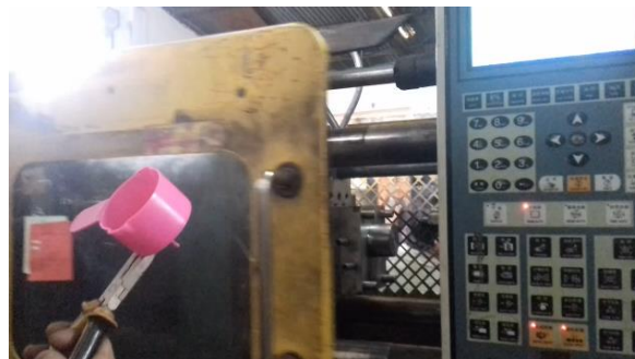
Gambar 5. Percobaan Dengan Suhu Dinaikkan Pada Suhu 170^{\circ}\text{C} – 200^{\circ}\text{C} dan Tekanan Dinaikkan 30 Bar Hasil Produk Jadi
