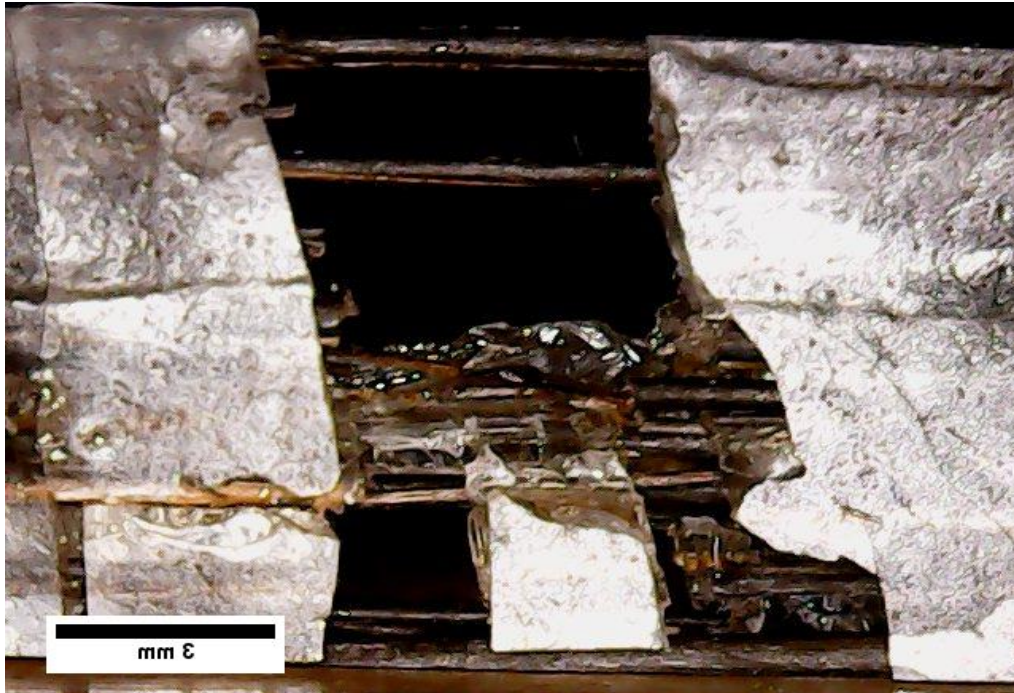
Gambar 4. Foto Mikro Patahan Spesimen Komposit Komposisi 30:70
