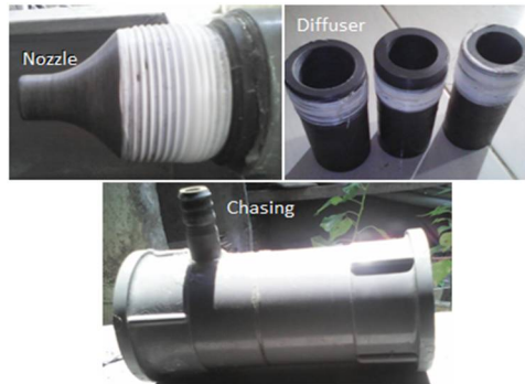
Gambar 5. Nozzle dan Diffuser venturi dengan variasi sudut 5^\circ , 6.5^\circ dan 8^\circ serta Chasing Vacuum Venturi
