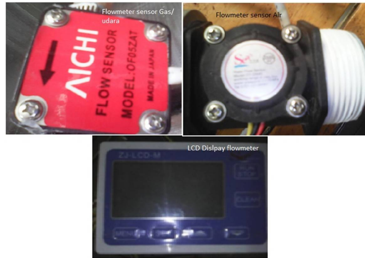
Gambar 3. Flow meter sensor digital untuk gas/udara dan air
