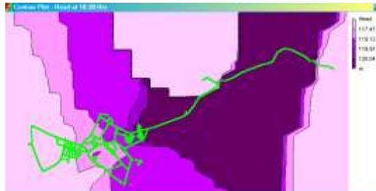
**Gambar 6.** Kontur Pressure pada saat Jam Minimum Pemakaian Air
