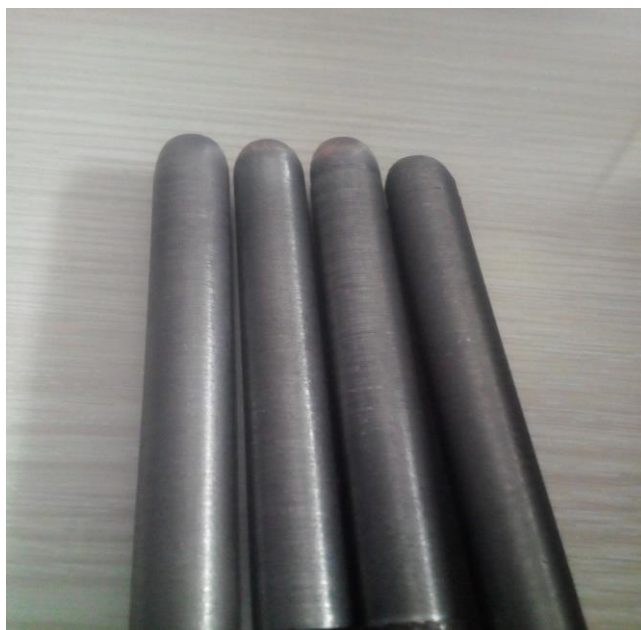
Gambar 2. Bentuk sumbat dan pencekaman tube pada mesin uji tarik menurut standard ASTM
