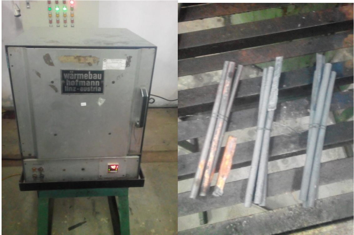
Gambar 3. Tungku Listrik untuk Perlakuan Panas dan pendinginan specimen setelah perlakuan panas
