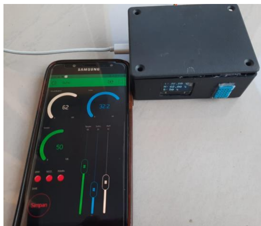
Gambar 12. Tampilan kondisi suhu dan kelembaban melalui aplikasi blynk dan layar LCD
