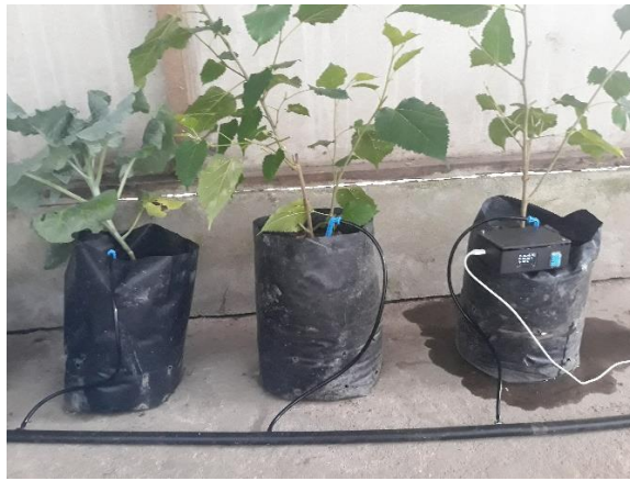
Gambar 11 Proses pengaturan kelembaban tanah melalui drip tetes
