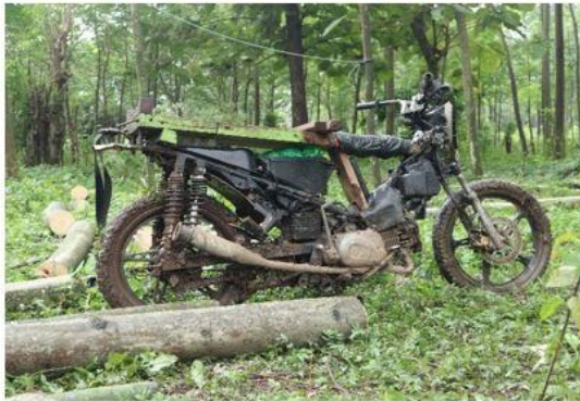
Gambar 2. Sepeda motor bekas yang dimodifikasi yang digunakan pada pengangkutan kayu di lokasi penelitian.
