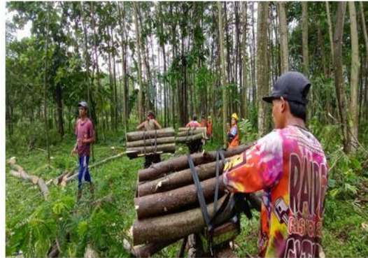
Gambar 2. Sepeda motor bekas yang dimodifikasi yang digunakan pada pengangkutan kayu di lokasi penelitian.
