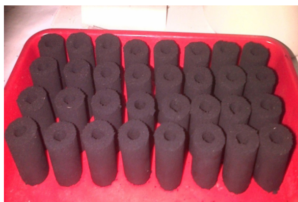
Gambar 12. Briket arang kulit buah nipah yang sudah siap untuk di uji dan dibakar
