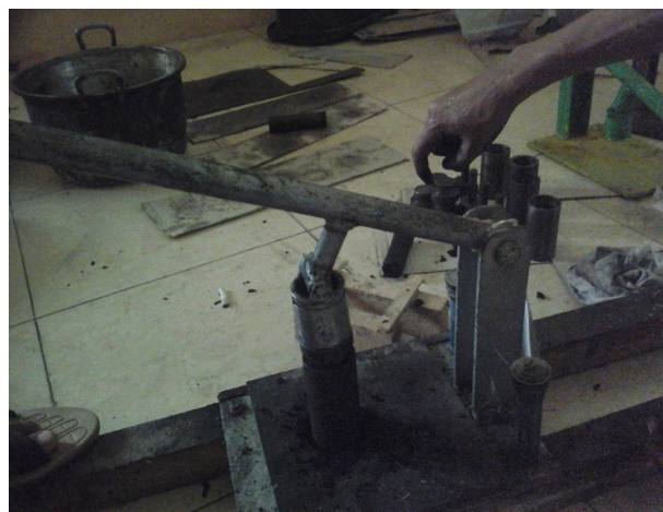
Gambar 11. Pengempaan dengan alat kempa tradisional
