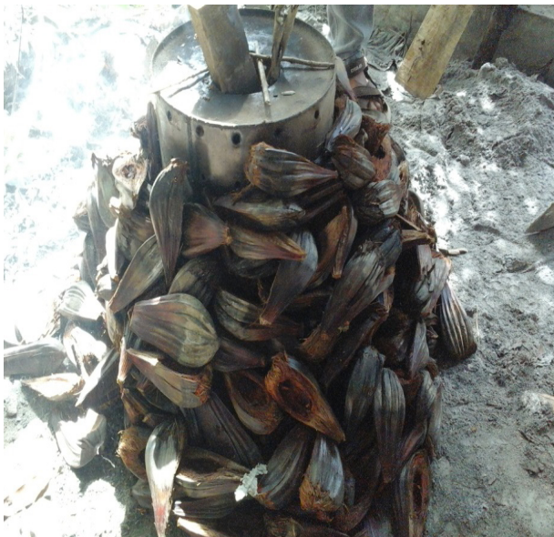
Gambar 5. Persiapan Proses Karbonisasi Gambar 6. Karbonisasi Kulit sabut buah nipah
