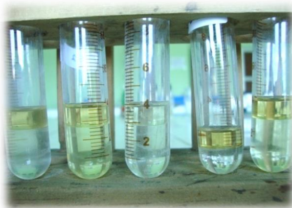
Gambar 5. Hasil sentrifus sampel minyak sawit curah setelah ditambah n -heksana (dari kiri ke kanan: penggorengan 1,2,3,4,5).
