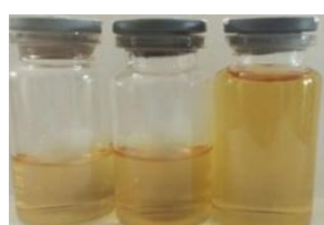
Gambar 3. Hasil sintesis AgNP secara reduksi kimia Ag^+ : PEG-6000 dengan variasi rasio mol 10:11 (a), 10:2 (b), dan 10:4 (c) berdasarkan fungsi waktu
