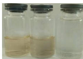
Gambar 3. Hasil sintesis AgNP secara reduksi kimia Ag^+ : PEG-6000 dengan variasi rasio mol 10:11 (a), 10:2 (b), dan 10:4 (c) berdasarkan fungsi waktu
