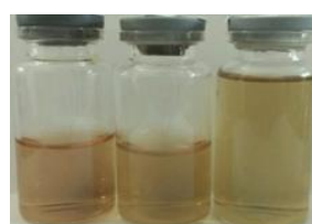
Gambar 3. Hasil sintesis AgNP secara reduksi kimia Ag^+ : PEG-6000 dengan variasi rasio mol 10:11 (a), 10:2 (b), dan 10:4 (c) berdasarkan fungsi waktu
