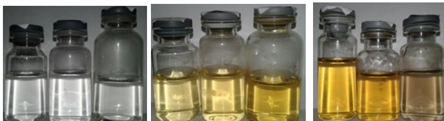
Gambar 1. Hasil sintesis AgNP secara reduksi kimia dengan variasi rasio mol \text{Ag}^+:\text{D}(+)\text{-glukosa} = 1:1 (a), 1:10 (b), dan 1:20 (c) berdasarkan fungsi waktu
