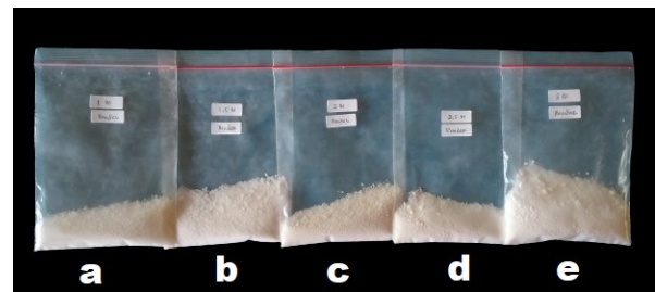
Gambar 3. Serbuk silika hasil variasi konsentrasi \text{NaOH} : (a) 1,0M (b) 1,5M; (c) 2,0M; (d) 2,5M; (e) 3,0M
