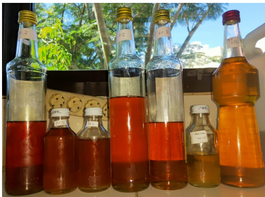
Gambar 1. Hasil esterifikasi minyak jelantah dengan variasi katalis
